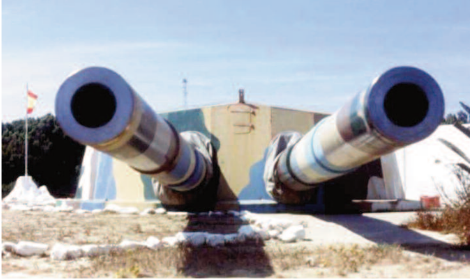
Montaje doble Vickers de 305/50 mm en la batería de El Cascabel, Tarifa.
